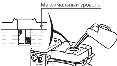
Рис. 8 Максимальный уровень топлива в топливном баке
