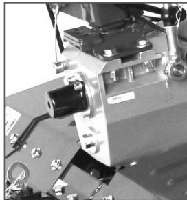
Рис. 17 Вал отбора мощности
